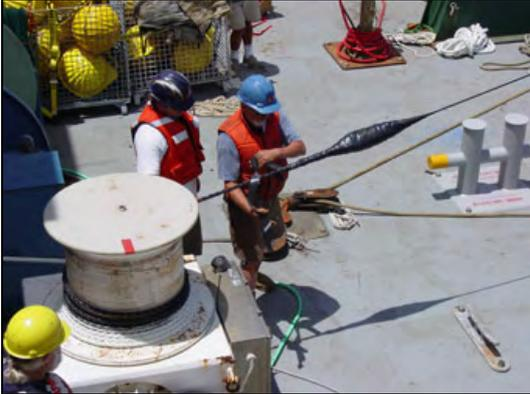
写真 4-1-2b-p1 Kilo Moana での甲板作業, キャプスタンによる巻き取り
