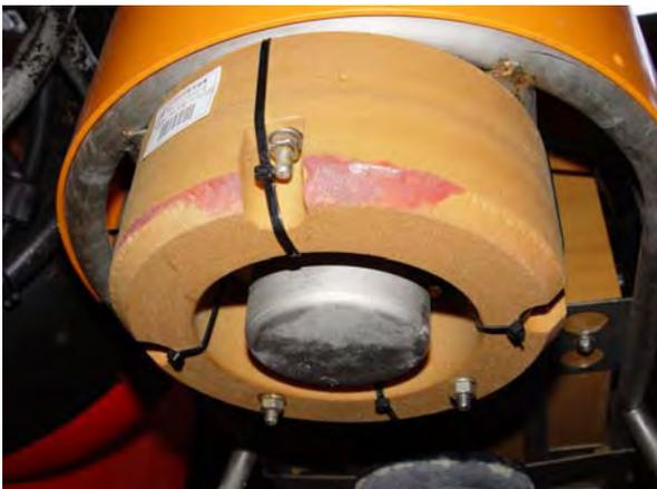
写真 4-1-2b-p8 昇降ブイの音響通信送受波器の周りを取り付けた浮力材。浮力材に含まれる多くの気泡により効果的に超音波が吸収され形状を工夫することにより超音波の指向性を制御することが可能になった。
