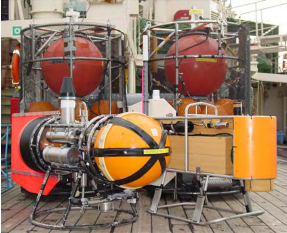
写真：水中ウインチ（上、奥）と、新SORST型（手前、右）・旧CREST型（手前、左）計測ブイ
