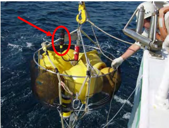
写真 4-1-2b-p10 Altimeter 海域試験。設置作業。赤丸部分が Altimeter の音響発信源。
