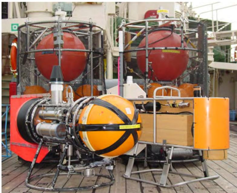
写真 4-1-2b-p7 CREST 型昇降ブイ(左: ~2006)、SORST 型 (Fish 型) 昇降ブイ(右: 2006 ~) 2006 年 08 月 淡青丸甲板にて。(形状比較最終試験を準備したが、台風のため実験途中で回収となった。) SORST 型に用いられている浮力材は、比重 0.3、使用深度 400m の Co-Polymerfoam を日本で始めて利用した。(その前まで切削可能な浮力材は、しんかい 6500 や ROV で用いられているシタチックフォーム(SF)しかなかった。SF の場合、比重 0.48 以上となり、結果として効果的な軽量化を図ることは難しかったかもしれない。Co-polymerfoam は、このプロジェクト以後、日本で開発される水中ロボットなどに利用され始めた。
