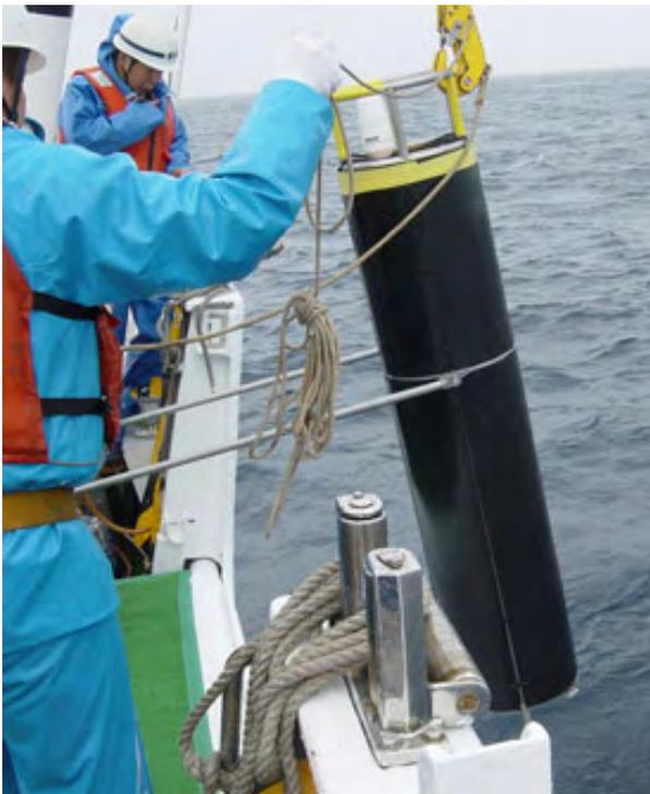
写真左：計測ブイの形状検討（縦型ブイ）
