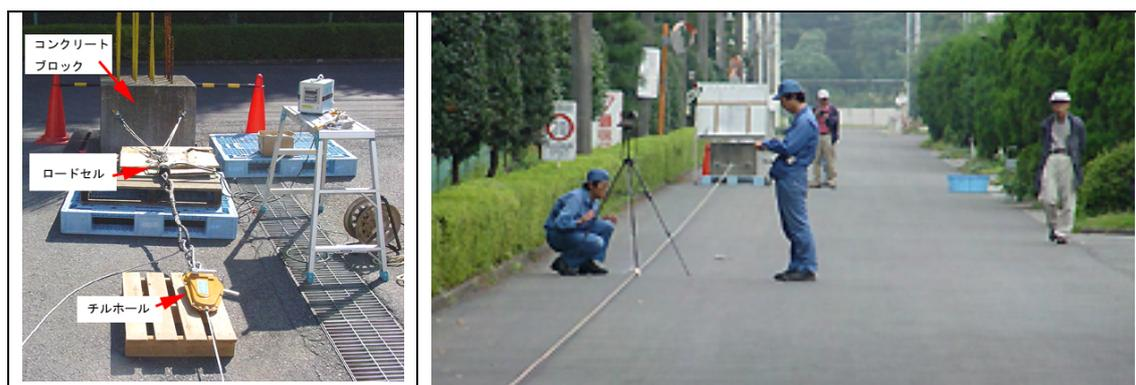
写真 4-1-2b-p4 ロープの負荷伸長計試験風景
