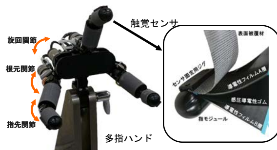
図 2-1 触覚センサを実装した高速多指ハンド
