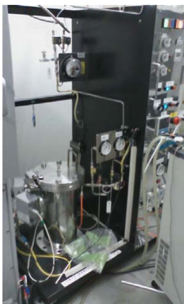
高酸素圧結晶育成装置 (フラックス法による結晶育成装置)
