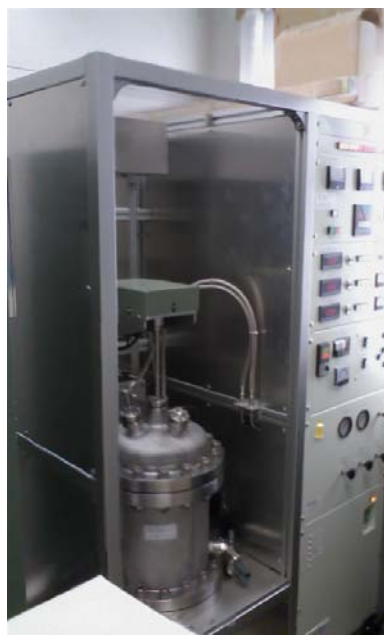
トップシード溶液成長装置 (高酸素圧対応)
