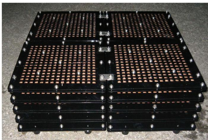
図 10. ビーズ型リン回収装置の外観。Zr-PVA が塗り込まれたビーズ(茶褐色)が外枠(黒色)に収められている。
