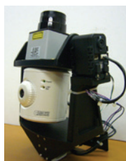
図 2 開発した パンチルト機構
