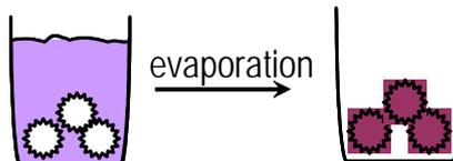
図 1-5 室温液相条件下で SWNHox 内に分子などを内包する方法。Nano-extraction 法では薬剤の溶液と SWNHox を混合するだけで薬剤が SWNHox に内包される。この方法は分子とグラファイトとの親和性が強いときに有効である。Nano-precipitation 法では、薬剤の溶液と SWNHox を混合し、溶媒を蒸発させる。この方法は、分子とグラファイトとの親和性が低くても適用できる。
