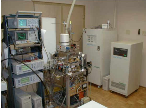
図 4. 先の CREST により開発し、チリ共和国ラス・カンパナス天文台内に設置したミリ波超伝導大気微量分子観測装置。右側の白い 2 つの筐体は液体窒素自動供給装置。冷凍機の圧縮機および音響光学型分光計は別室にあり、ここには写っていない。
