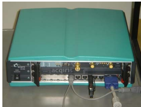
図 16. デスクトップ PC サイズのデジタル分光計。
