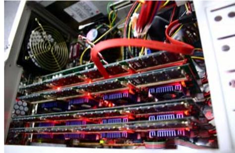
図 3. 専用基板 4 枚装着時の PC
