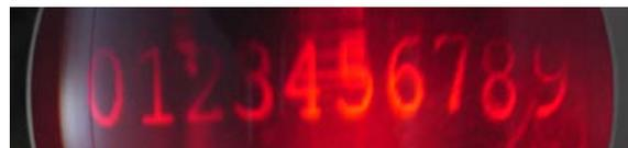
図 12. 3 枚の LCD による再生像
