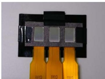
図 10. 3 枚の LCD による表示パネル
