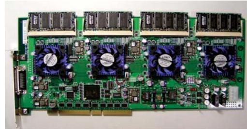
図2. ホログラフィ計算専用HORN-5ボード
