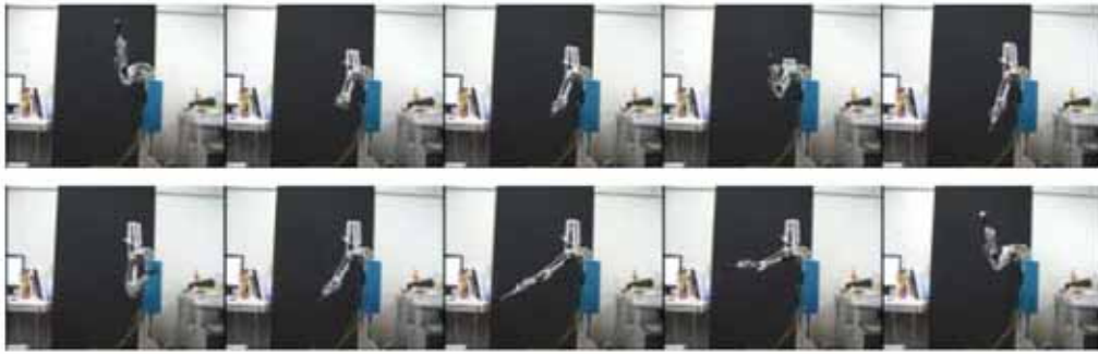
図4 正確な位置決めと関節の剛性調節が可能な空気圧式ロボットアーム。 音楽に合わせて、二拍子、三拍子、四拍子の指揮動作を行っている。
