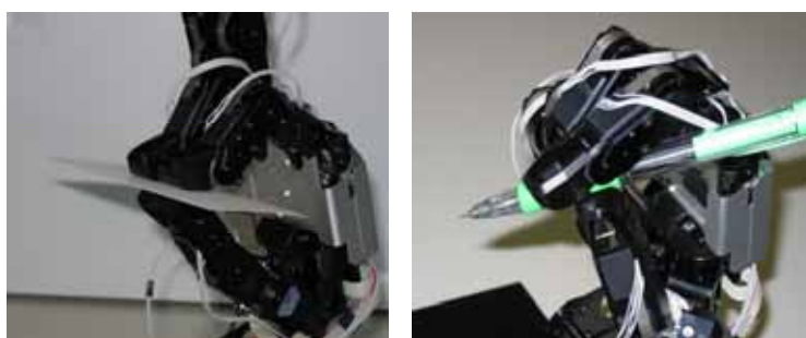
図3 薄いものや壊れやすいものを安定して把持することのできるヒト型ロボットハンド。
