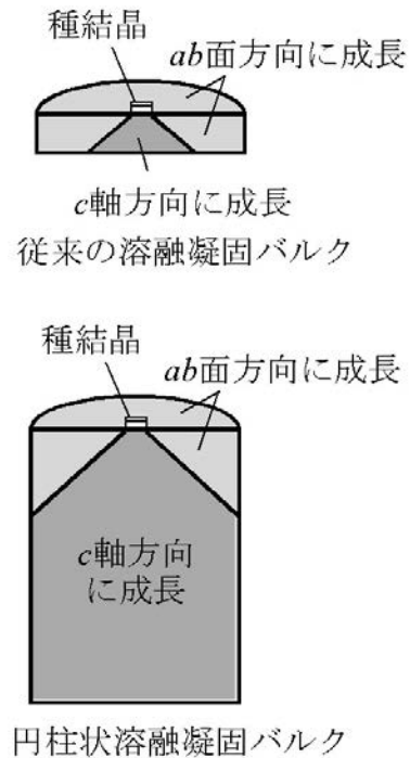
図 9. 溶融凝固バルク断面の概念図。背が高い円柱状バルクでは c 軸成長領域が大半を占める。
