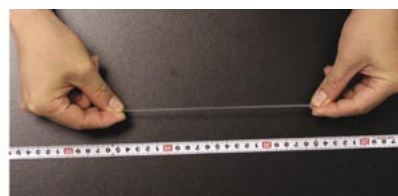
図1 トポロジカルゲルの伸長の写真。 含水率 90% のゲルが 14 倍に伸びている。
