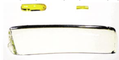
図3 トポロジカルゲルを利用して作成した ソフトコンタクトレンズのサンプル
