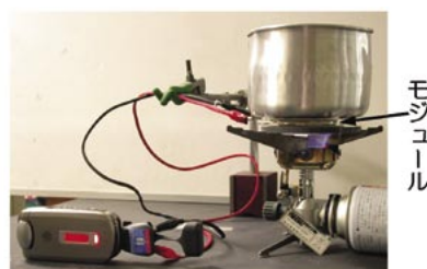
図3 小型ガスコンロを用いた熱電発電による携帯電話の充電
