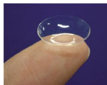
図3 トポロジカルゲルを利用して作成した ソフトコンタクトレンズのサンプル
