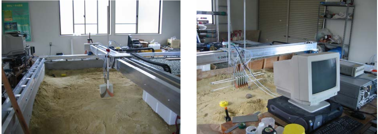
図1 地中レーダテスト中の SAR-GPR アンテナ
