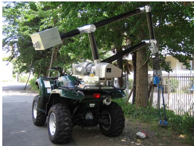
図 5 Grizzly 車両の金属探知機を搭載した探査モード
