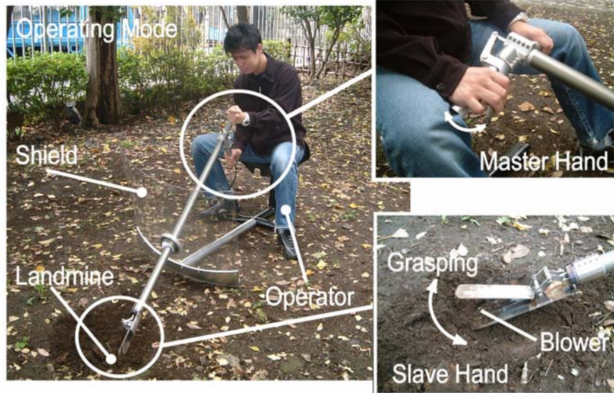
図 7 Mine Hand の全景と各部の詳細 (遠隔ハンドリング、ブロー、ブラシによる砂の除去も行う)
