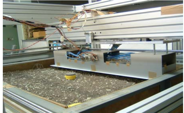
アレイアンテナレーダシステムと TYPE-72 地雷
