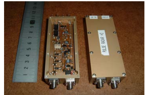
図1 超小型地雷探査レーダユニット
