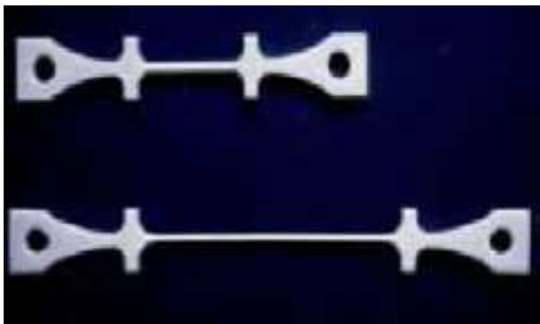
引張試験による超塑性変形
