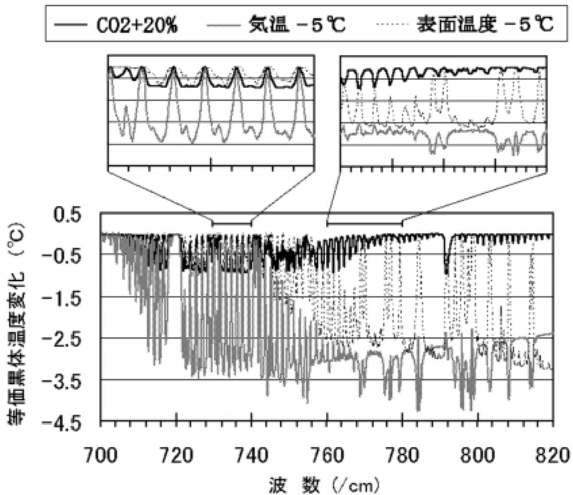
図1 シミュレーションにより得られた人工衛星から測定される赤外放射強度変化。CO<sub>2</sub>濃度変化と気温変化はともに高度0～5 kmの範囲で一様に变化させた場合。
