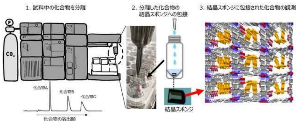
図 2-5 超臨界液体クロマトグラフィーと結晶スポンジ法を連結した分析系 52
