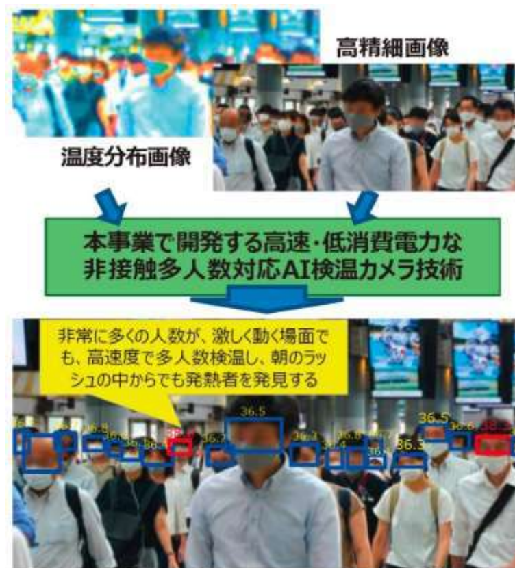
図 2-9 高速・低消費電力 AI 検温カメラ技術と高速検温イメージ 38
