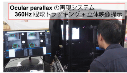
図2 (B) (左) 眼球の模式図. (右)低遅延な Ocular parallax レンダリングシステムの様子.
