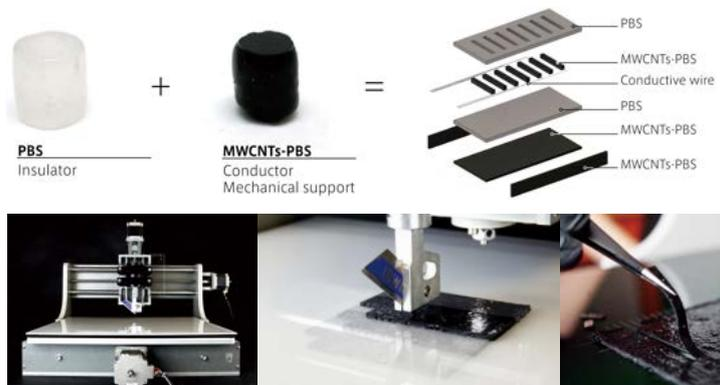
絶縁性の修復素材PBSと、導電性かつ機械的強度が調整可能な修復素材MWCNTs-PBSを用いてデバイスを作製するために、シート上の素材を3次元に積み上げる方式のファブリケーションを提案した。まず、市販のCNCマシンを改造し、入力された設計をGコードに変換して素材を切断する装置を作った。次に、予め準備しておいた素材のシートを目標の形状に加工して積み上げた。素材同士が自己修復するため、シート同士の機械的・電氣的な接続に接着剤などは不要である。また、導電性修復素材と通常の電気配線の接続も、素材の機械的修復を利用することでほとんど付けなしに行うことができる。
