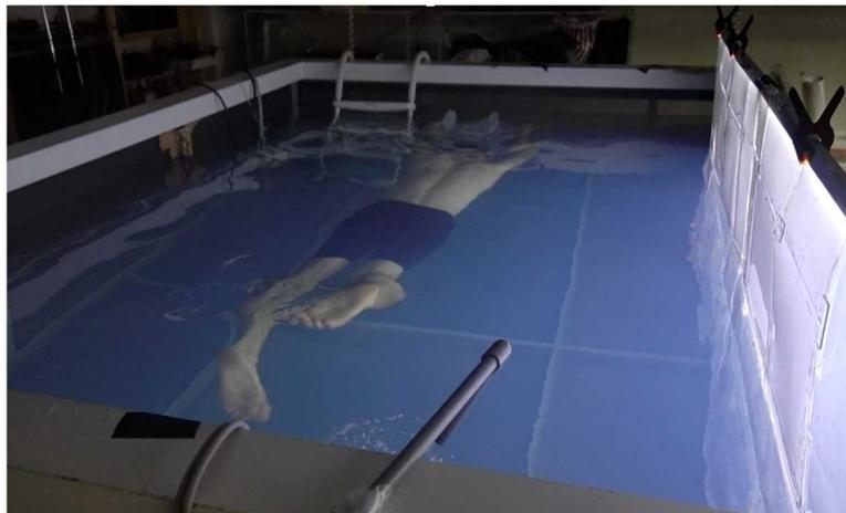
図 1 人が泳ぐ際に起こす水の流れを可視化し観測する実験
