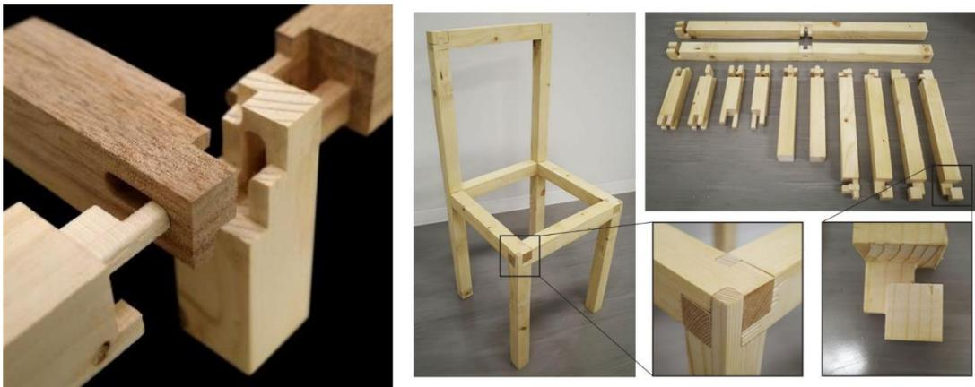
図1 左: 開発したシステムを利用して設計・製作した接合部の例。右: 開発したシステムを利用して設計・製作した椅子の例。釘や接着材を使わずに、組み立て、分解、再組立てが可能である。
