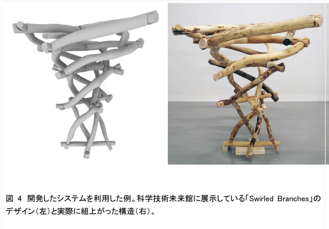
図 4 開発したシステムを利用した例。科学技術未来館に展示している「Swirled Branches」のデザイン(左)と実際に組上がった構造(右)。
