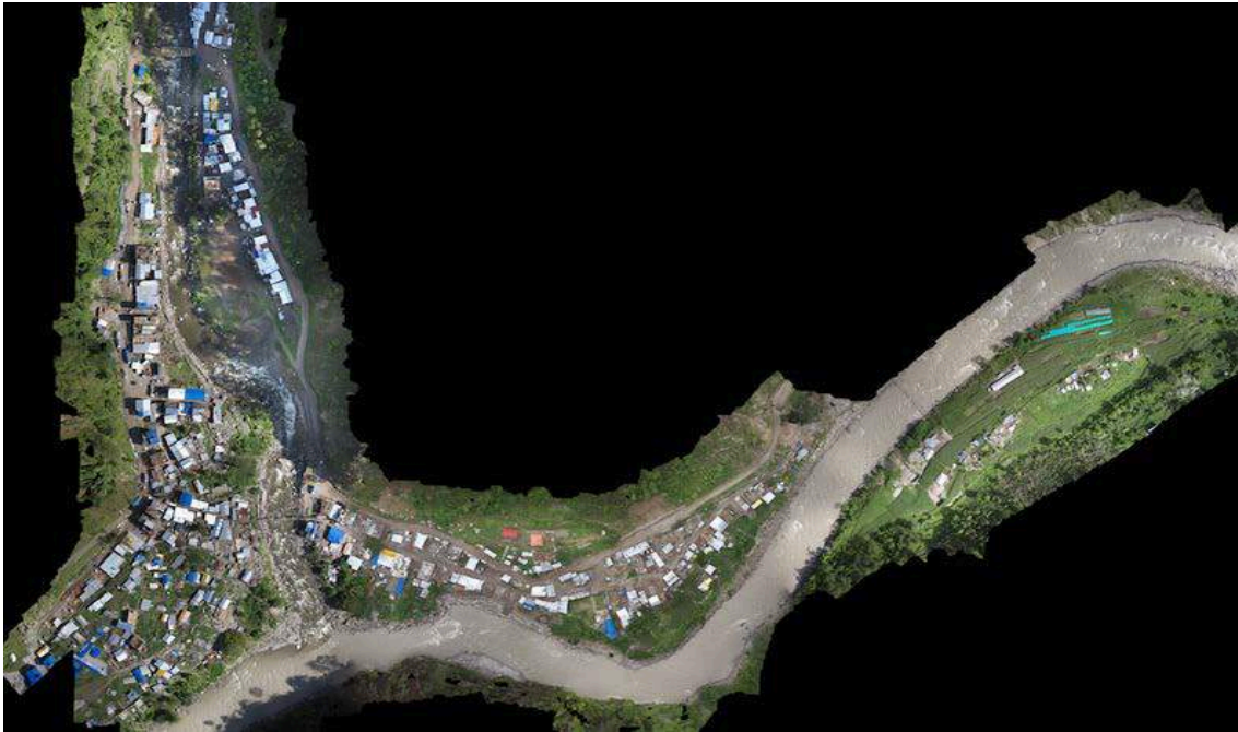
図2 2016年2月および6月にドローン（UAV）を用いて撮影した多数の写真から作成したオルソ・モザイク画像（シンガティ）。東から西に流れる川はタマコシ川で、画像左側には北から南に支流が流れて、タマコシ川と合流しています。
