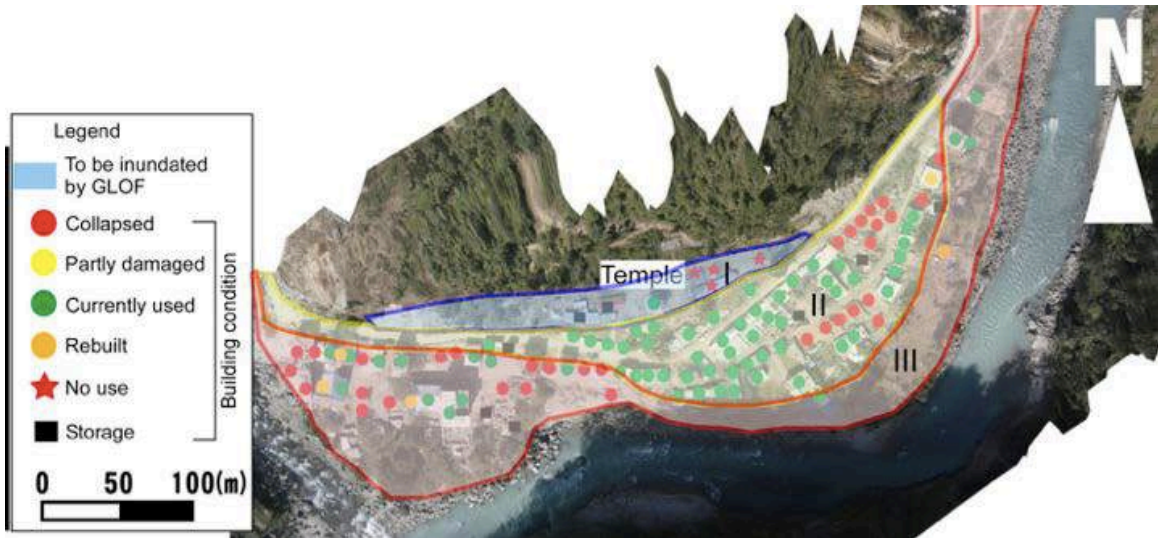
図3 タマコシ川上流部、シンガティ東部地区の河岸段丘面区分と家屋の分布
