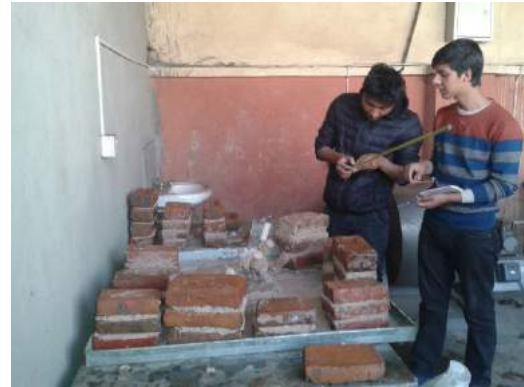
図-7 レンガ供試体の作成
