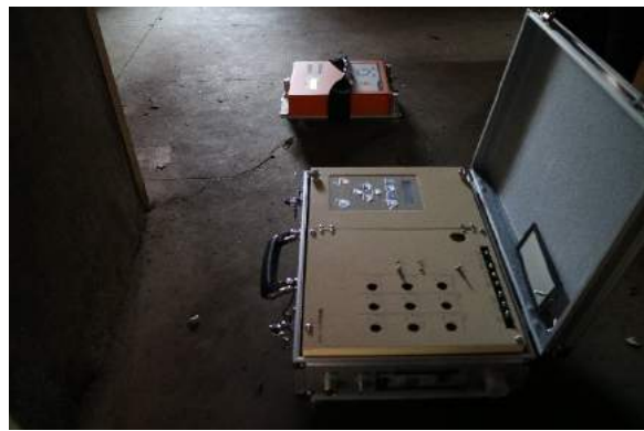
図-12 2階の床で観測中の微動計
