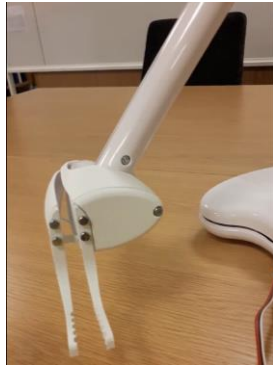
図6. 多用途グリッパーのプロトタイプ a) 箸型 b) 歯ブラシ型 c) ピックアップ型
