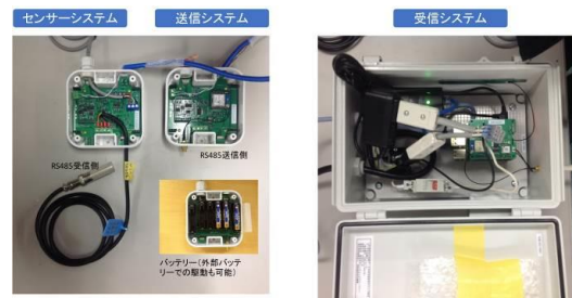
図2 RS485 によるマルチベンダー対応ボード
