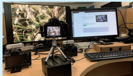
東京大学フィールドフェノミクス研究拠点に構築したリモート共同開発環境：インド側との遠隔操作により、Edge-Computing ツールキット開発を実施
