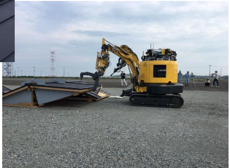
建設ロボットによる倒壊家屋の探索作業
