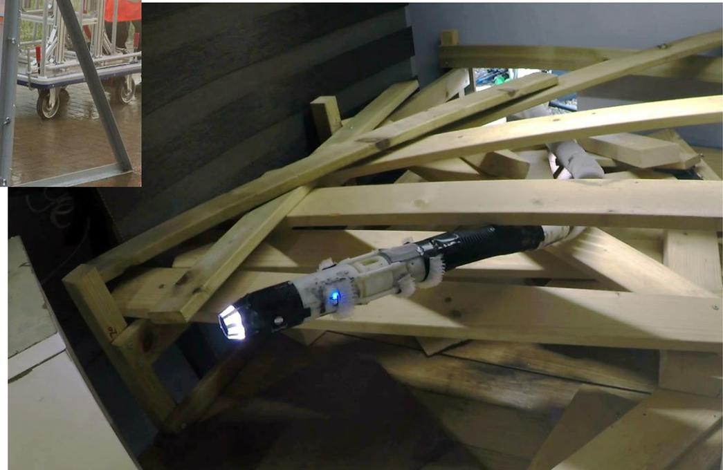
空気浮上型能動スコープカメラによる探査
