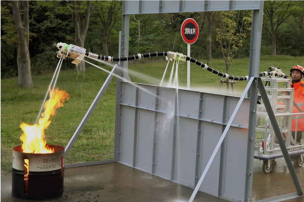
空飛ぶ消火ホース型ロボット・ドラゴン
