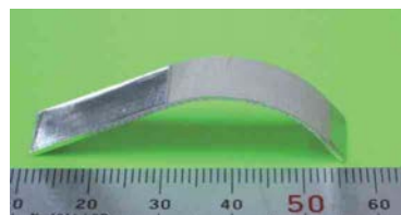
▲純アルミニウムのレーザー ピーンフォーミング (板厚1mm)
