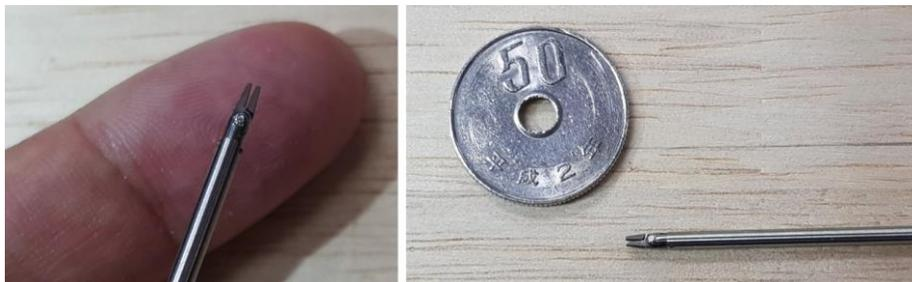
図 4. 直径 2mm の超微細鉗子
