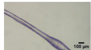
図 3 直径 100 \mu\text{m} 未満の中空微小血管モデル
