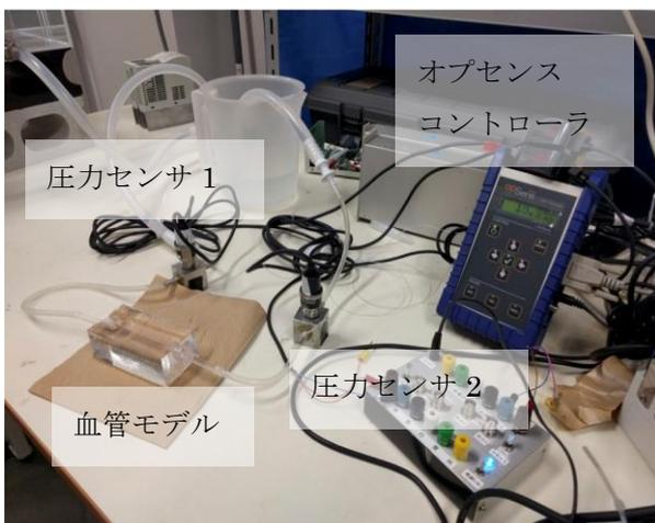
図1 圧力センサワイヤ妥当性評価のための循環システム。血管モデルの前後に評価用圧力センサを配置し、妥当性を評価できる。
