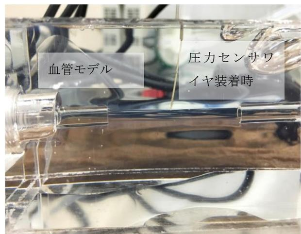
図2 圧力センサワイヤの装着状況（血管モデルが透明なため、圧力センサワイヤの装着を観察することができる）
