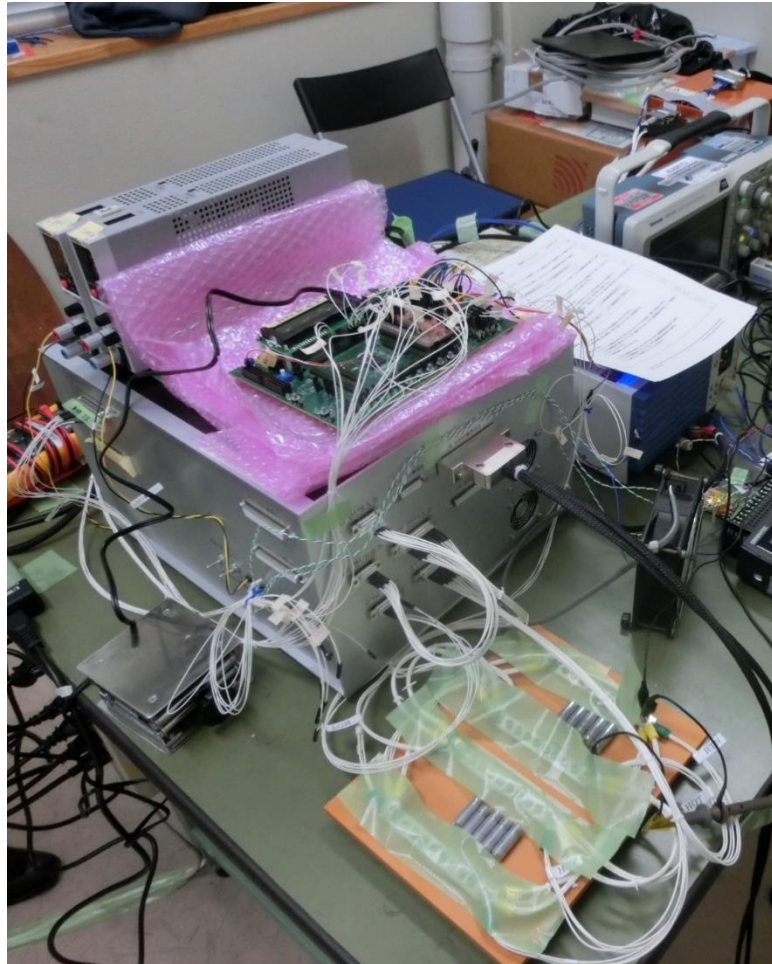
図 2-2-5 電源制御分配器器
