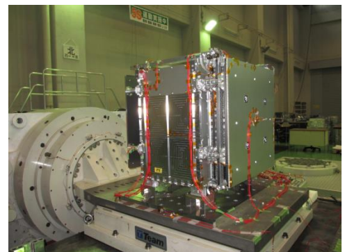
図2 模擬構体とアンテナ機械モデルの打ち上げ振動試験
