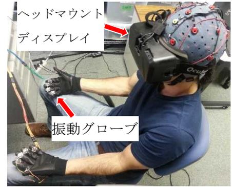
そこで c) として、運動に限らず、出しやすい脳波パターンをまず求め、これを用いて BMI を行うことを試みた。まず被験者にリアルタイム (遅れ = 0.5 秒程度) で自身の脳波パターンを呈示し (右図)、特定のパターンが安定的に現れるようなイメージ (運動、記憶、味、など) を 10 個選ぶ。次に、選ばれたそれぞれのイメージを繰り返し想起してもらい、ここからすべての組み合わせで識別器を構成、安定した識別が可能なものを選択し、これを用いてアンドロイドを動作させる、という実験を行った。この実験も全体の成功率は低かったが (65%程度)、単なる動作や記憶の想起より、目的を持った動作を想起する場合に成功率が高くなる傾向が見られた。
