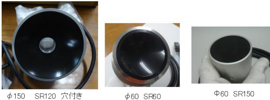
図 1. お椀型センサの整合層の写真
