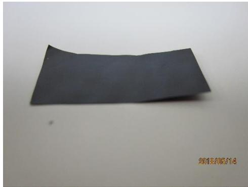
図 1 : ナノカーボン材を利用した薄膜
