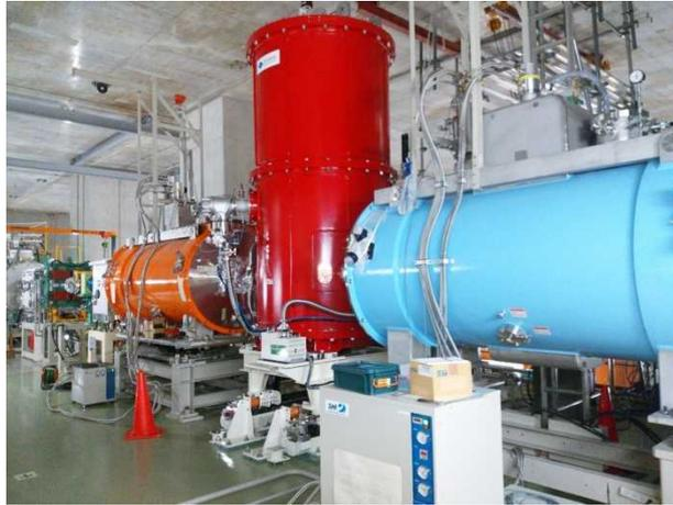
図 1 完成した超伝導 3 連 4 重極電磁石(水色)と RF デフレクタ(赤色)。
