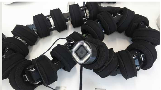
図 2 新型触覚センサを搭載した太径索状ロボット
