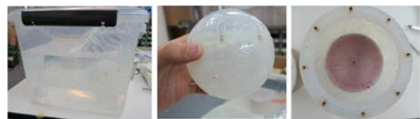
図3：マイクロホンアレイ耐水試験(12時間の水没テストをパス)
