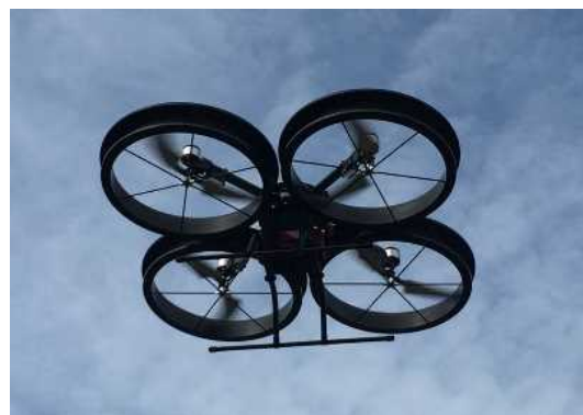
図 1 可変ピッチ・ダクテッド・ロータ仕様クアドコプター試験機
