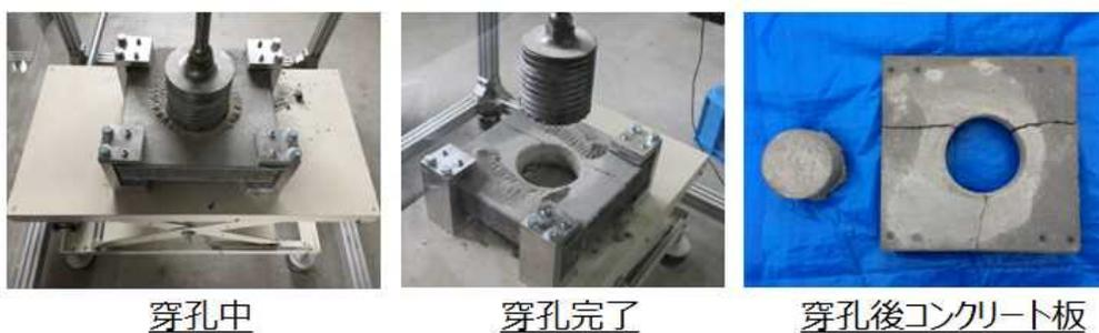
図 2 : コンクリート板穿孔過程
