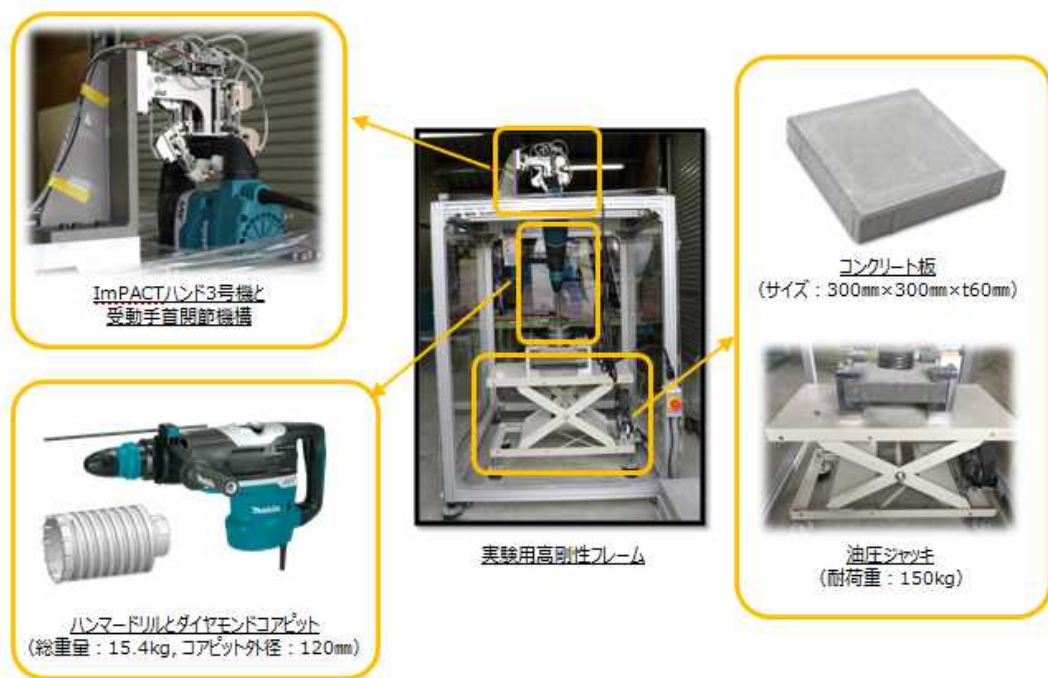
図1：コンクリート板穿孔実験セットアップ
