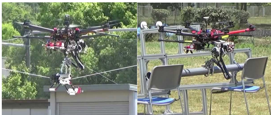
図2 左：ロープにパン・チルドステージのついたカメラを設置および回収（設置した装置の質量：1 kg） 右：鳥が木の枝に留まるように、パイプを掴み着陸および離陸（着陸時プロペラは停止）
