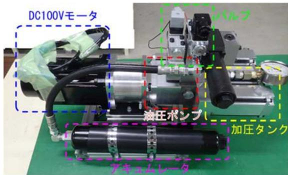
図2 電動式パワーパック外観
