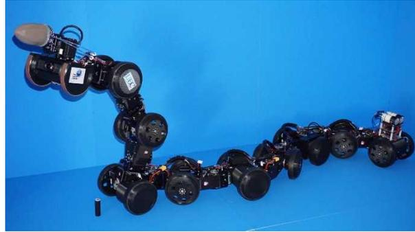
図 1 : 車輪型索状ロボット T<sup>2</sup> Snake-3
