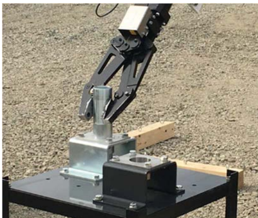
図5 フィールド評価実験(ピンの嵌合作業)の様子 (平成 29 年 11 月)
