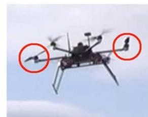
図 1 プロペラ停止飛行
