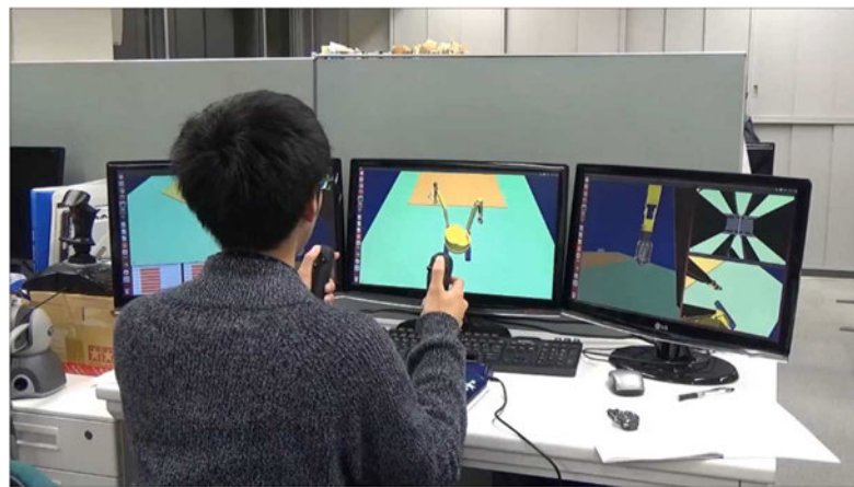
図6 複腕建設ロボットプラットフォームの操縦インターフェース検討用のシミュレータの外観
