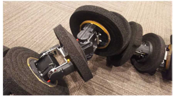
図 3 触覚センサを搭載した非車輪型索状ロボット
